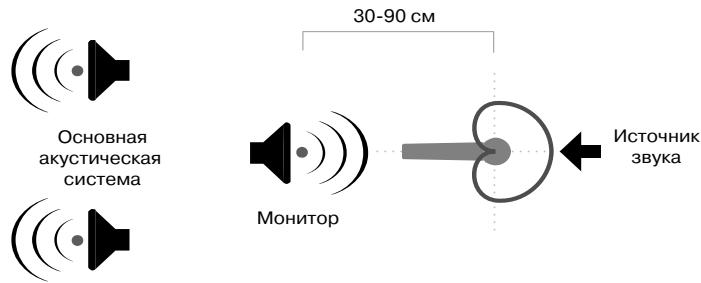
2. Располагайте микрофон на максимальном расстоянии от отражающих поверхностей и акустических колонок.
