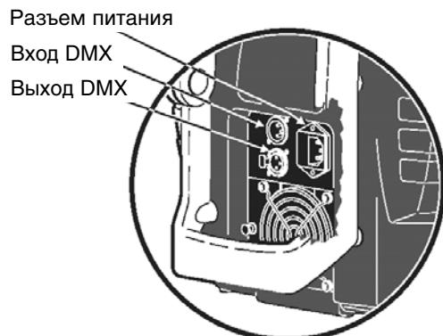
**Внимание! Кабель питания должен быть исправным и соответствовать электрическим требованиям всех подключаемых устройств!**
