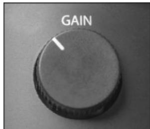
Регулятор усиления (не путать с регулятором громкости) на вашем микшере, интерфейсе или портативном рекордере поможет вам создать идеальный сигнал, лишенный шумов.
