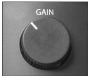
与音量不同的是，您的混音器、接口或便携式录制设备中的增益设置可以确保产生的信号尽可能达到绝对最佳的无噪声效果。该神奇的旋钮可以控制话筒的敏感度，从而对您获得的音质产生巨大的影响。如果敏感度调得太低，则无论您说什么，都没人能听得清。而如果调得太高，话筒会拾取您房间里的回声、空调声、椅子的挪动声、邻居的吵闹声，以及您听到的各种声音。以上情况都不理想。所以，抓住增益旋钮，边说边听。在调低增益时，将话筒靠近嘴部，音量会保持不变，但音效会显著提高。找到您满意的效果后，就可以开始了。
