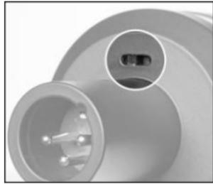
Auf der Unterseite des Mikrofons befindet sich außerdem ein kleiner Schalter zur Steuerung des eingebauten Hochpassfilters. Mit diesem praktischen, kleinen Schalter können Sie unerwünschtes Dröhnen und Rumpeln (falls erforderlich) herausfiltern, ohne es später mit Hilfe des Equalizers „reparieren“ zu müssen.
