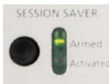
Рядом с секцией «Mic-Pre and A/D» над переключателем «Clock Select» расположен переключатель «Session Saver». Нажмите на него один раз для запуска. После запуска контура (индицируется соответствующим светодиодом) сигнал будет автоматически подавляться в случае клиппинга. Это отличный способ защитить Вашу систему от перегрузки, особенно при продолжительной работе с сильными сигналами.
