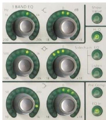
Liquid Channel™ оснащён новым цифровым эквалайзером (в его основе скорее ‘моделирование’ а не ‘свёртка’), созданным на основе классического звука Focusrite ISA 110. Это позволяет производить более тонкую коррекцию частот. Все настройки эквалайзера могут быть сохранены вместе с настройками предусилителя и компрессора в одном из программных ячеек (смотрите раздел DATA SELECT ниже).
