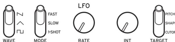
В зависимости от цели, LFO может обеспечивать вибрато (PITCH); изменение тональности осцилляторов (SHAPE); или эффект “вау-вау” (CUTOFF).
