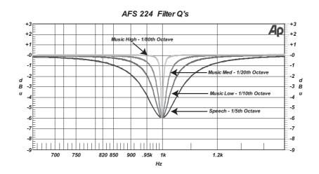
Отключение скользящего фильтра (Live Filter Lift): Отключение скользящего фильтра обеспечивает максимальную целостность звука, путем удаления неиспользуемых фильтров обратной связи. Эта кнопка используется для выбора времен скользящего фильтра как показано ниже
