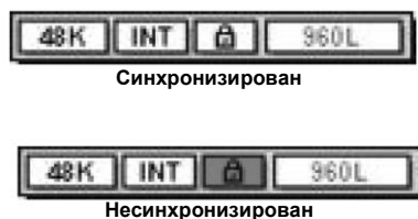
Рис. 4-4. Синхронизированный и несинхронизированный источник синхронизации по слову
