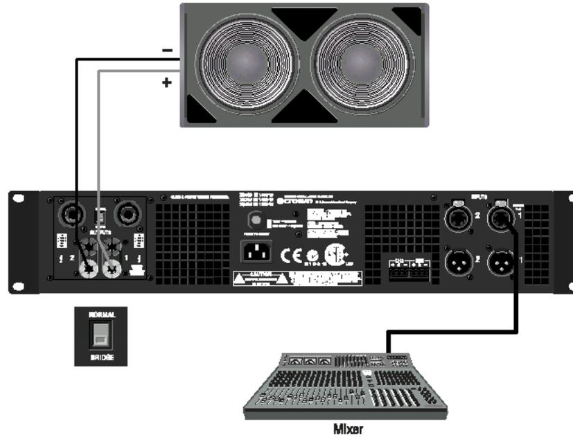
рисунок 2.11 Разводка Мост-Моно 2-х канальных моделей
