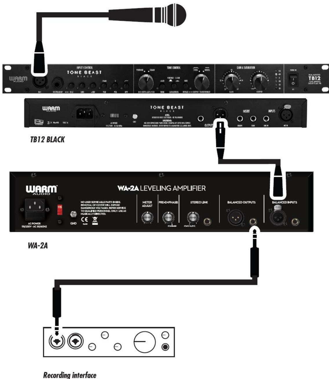
В данном примере микрофон подключается в TB12 Black, который подключается к WA-2A с помощью балансного соединительного кабеля типа XLR; WA-2A подключается к линейному входу вашего звукозаписывающего устройства /интерфейса.
