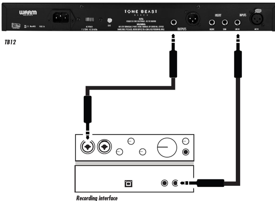
В данном примере TB12 Black подключается в разрыв звукозаписывающего устройства. Это полезно при использовании TB12 Black в качестве «аналогового плагина» или при подключении в разрыв шины микширования. Устройство звукозаписи подключается к TB12 Black с помощью балансного кабеля 1/4" через линейный выход. Затем устройство звукозаписи принимает информацию от TB12 Black через линейный вход.
