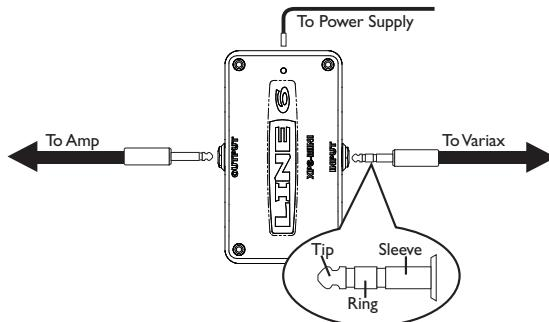
Подключение Variax через XPS Mini осуществляется очень легко. Используйте прилагаемый TRS-кабель (или попросту стерео-кабель) для подключения Variax ко входному разъему XPS. Подключите блок питания к разъему "Power" на XPS и через стандартный 1/4" моно гитарный кабель соедините выход XPS со входом вашего усилителя или педалей эффектов.
