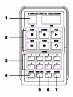
Панель записывающего устройства разделена на 7 основных секций:
