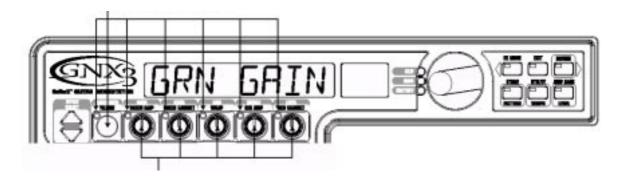
Ручки используются для регулировки усиления, EQ и уровня Зеленого Канала.
