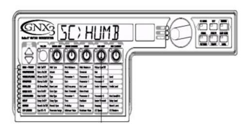
Поверните ручку номер 4 до тех пор, пока на дисплее не высветится индикация SC > HUMB.
