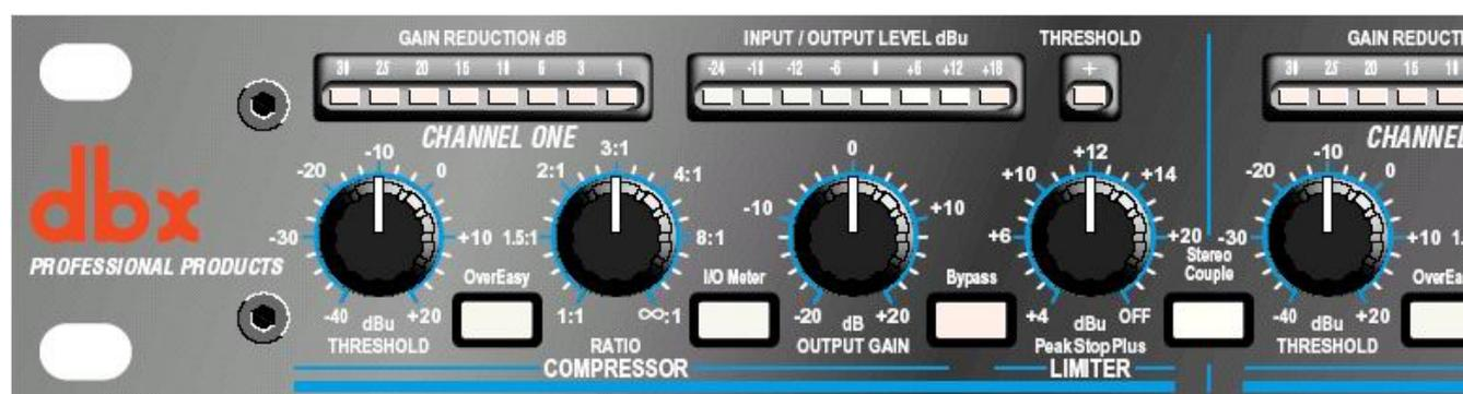
**Gain Reduction dB** - 8-сегментный индикатор в диапазоне от 0 до 30 дБ отображающий величину подавления чувствительности в результате компрессии и/или применения функции Intelligent Predictive Limiting®.
