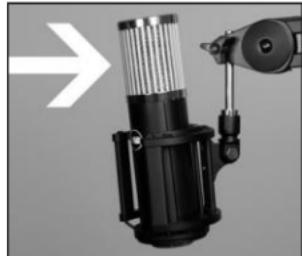
Skylight — это микрофон «бокового адреса». Это означает, что он улавливает источники звука, находящиеся сбоку от микрофона, а не спереди. Для удобства использования, рабочая часть корпуса микрофона обозначена значком 512 Audio, поэтому вам просто нужно направить сторону со значком к источнику звука, который вы хотите записать.
