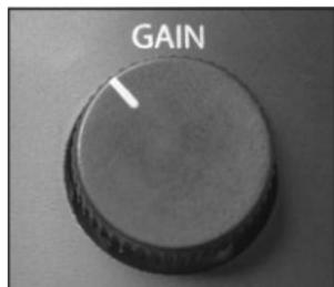
与音量不同的是，您的混音器、接口或便携式录制设备中的增益设置既可以提供清晰无噪音的信号，也可以根据您的创意喜好来调整录音的音调。该非常重要的设置可以控制话筒的灵敏度，由此您可以确定要将房间中的声音以及您或乐器的声音录制到什么程度。调低增益并靠近话筒会产生一种能听见呼吸声的亲密音调，这非常适用于可能雇用您作旁白的大型电影的预告片。这也可减少话筒会听到的混响声和房间回声。同理，调高增益并远离话筒可以捕
