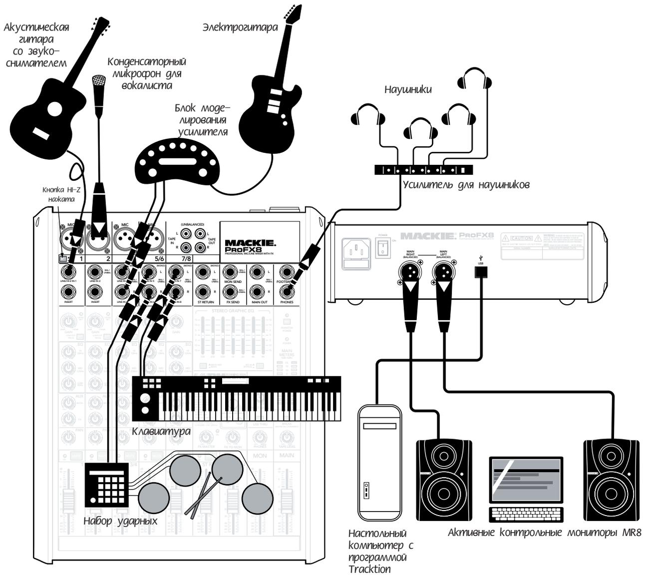
На данной схеме показано подключение акустической гитары непосредственно к каналу 1 (при включенной кнопке hi-z); подключение конденсаторного микрофона к каналу 2; подключение гитарного усилителя к линейному входу каналов 3/4; подключение ударной электроустановки к каналам 5/6, а также подключение клавиатуры к каналам 7/8.
