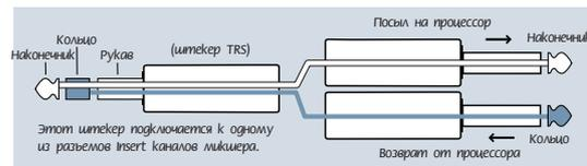
Разъемы Insert используются в качестве прямых канальных выходов; расположены после усиления и перед эквалайзером. В разделе на стр. 28 (рисунок F) представлены три способа использования подключений инсертов.
