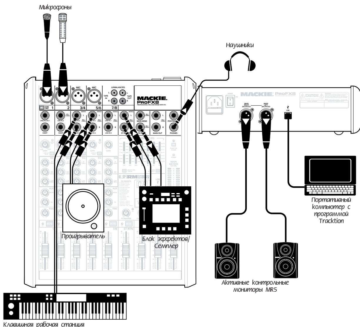
На данной схеме представлено подключение микрофонов к микрофонным входам каналов 1 и 2, подключение клавиатуры к линейным входам каналов 3/4, и подключение проигрывателя к линейным входам каналов 5/6. Процессор эффектов/семплер принимает монофонический входной сигнал посылы эффектов, а его стерео выход подключен к входам стерео возврата.
