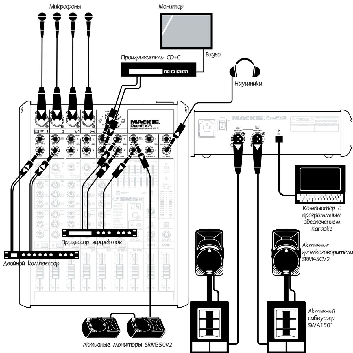
На данной схеме представлено подключение микрофонов к каналам 1 – 4, подключение проигрывателя CD+G к линейным входам каналов 7/8. Процессор эффектов принимает монофонический входной сигнал посылы эффектов, а его стерео выход подключен к входам стерео возврата. Двойные компрессоры подключены к инсертам каналов 1 – 2 для сжатия вокала.
