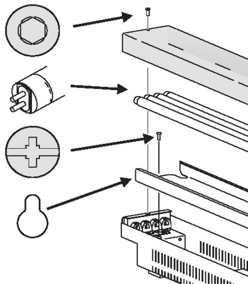
3. Используя крестовую отвертку, отверните два болта, удерживающих внутреннюю крышку устройства. Снимите ее
