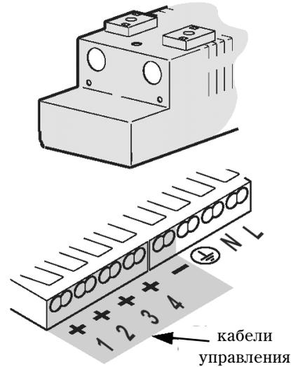
По находящимся внутри прибора проводам управляющий сигнал подается на вторую группу разъемов. Отверстия для входных/выходных кабелей расположены на обоих торцах прибора. Если Вы подключаете устройство по цепи к другим Cyclo того же типа, выполните вышеописанные операции на второй группе разъемов устройства для подключения к следующему прибору.
