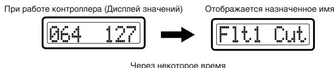
*Обычно, каждый суб-дисплей отображает имя энкодера или слайдера, но одновременно только одно. Для проверки не отображаемого имени нажмите кнопку [ENTER].*
