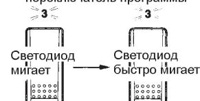
Если при настройке необходим режим Mute (отключение звука), то нажмите и удерживайте более 1 секунды переключатель программы с мигающим светодиодом. При этом включится режим Mute, и светодиод начнет быстро мигать.
